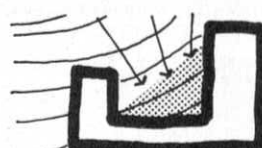
EVITAR EL ESTANCAMIENTO DE AGUA
