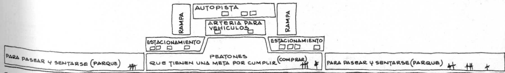
COMPLEJO INTEGRADO POR UNA AUTOPISTA Y CENTRO COMERCIAL
